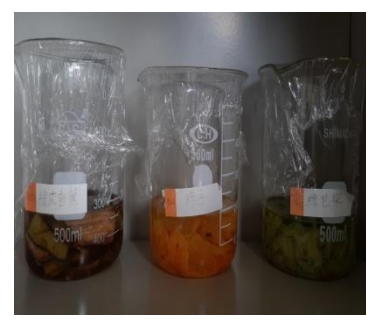
3. 放於陰涼處室溫(28 度)下開始浸泡，浸泡 24 小時
