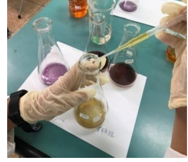
6. 浸泡液進行鞣酸含量測量
