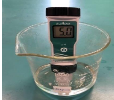
2. 檸檬酸及小蘇打溶液調配 pH(4、5、9、10.2)溶液 100 ml
