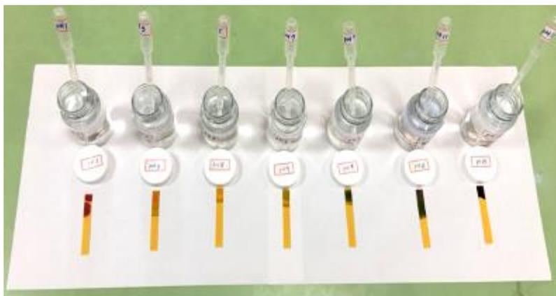
以 pH 計配製水溶液並用廣用試紙測試是否符合對應顏色
