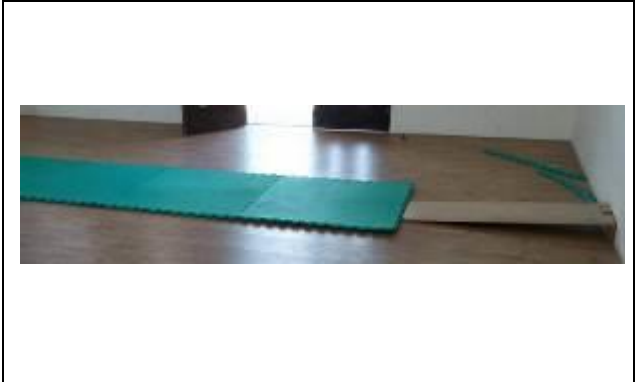
【圖 2-7】 斜坡下鋪軟墊，地面不夠平坦，實驗誤差大
