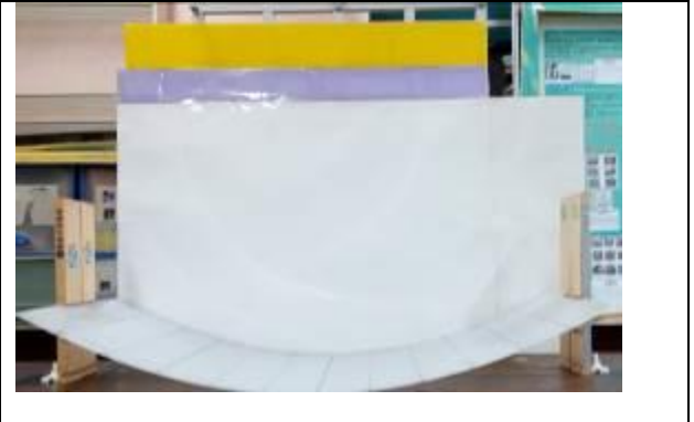
【圖 2-8】U 型坡道長度 118.5cm 水平距離 114 cm 兩側高度 17 cm
