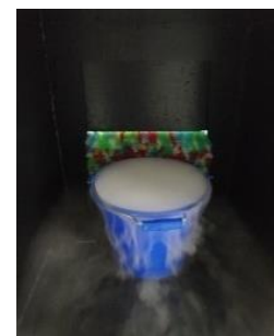
我們利用乾冰觀察氣流的流動情形。
