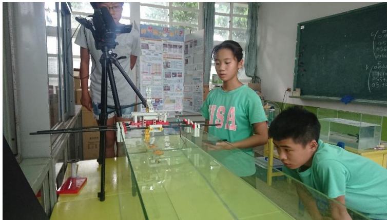
用自製裝置測量和紀錄，機械魚擺動尾鰭產生的前進推力
