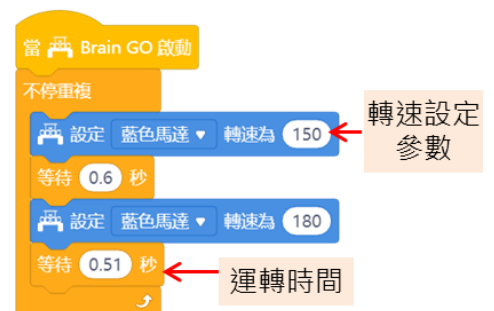
圖 2：以 m block 撰寫控制馬達的程式
