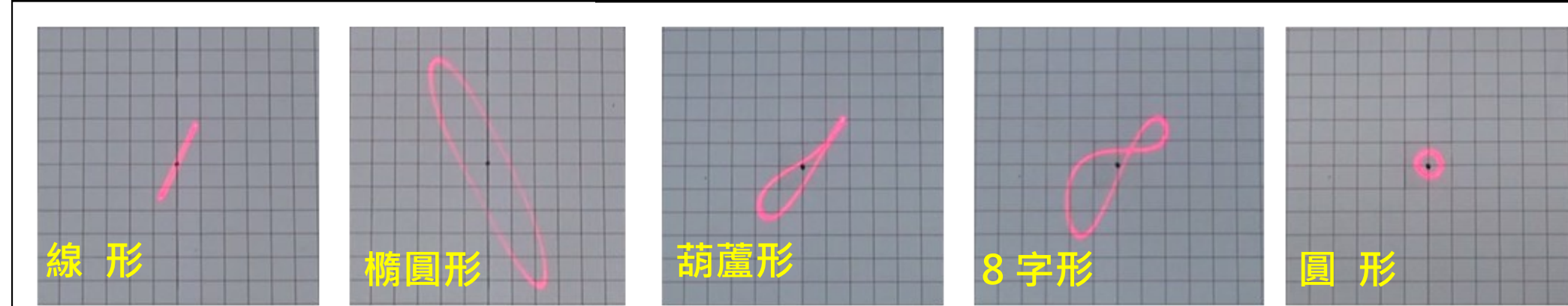
圖 9-7：將會產生圖形變化的 400 個單頻音依據「圖案類型」可分成五大類。
