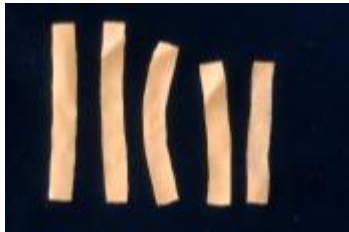
圖 8-9：裁剪成數段寬度 1cm 的長條狀氣球皮。
