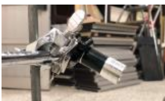
圖 2-8：以鐵架固定雷射光筆，並使雷射光筆朝斜下方角度，以避免直射眼睛的危險。
