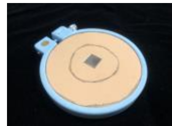
圖 7-4：將 A 圓的圓周記號調整至繃框內框邊緣處，即屬「高度緊繃」。
