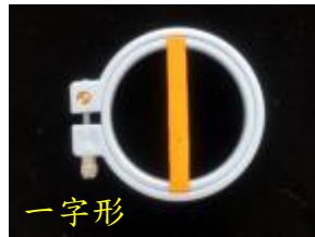
圖 8-10：將長條狀氣球皮分別以【一字形】、【十字型】、【X 字形】方式固定於 B 繃框上。
