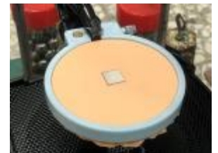
圖 2-5：使用特製繃框固定氣球皮，在氣球皮上黏貼鏡面紙，以反射雷射光之用。
