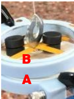
▲ 圖 8-6：B 繃框上黑色磁鐵彈跳時會敲擊 A 繃框上氣球皮，以模擬受聲波擾動的不同狀態。
