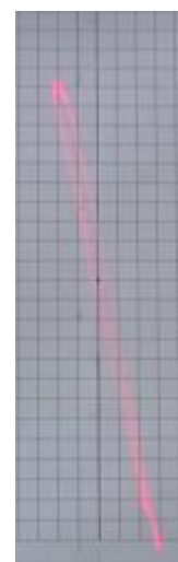
圖 7-9：「中度緊繃」氣球皮 233Hz 時最大圖形長度 22.2cm。
