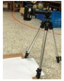
圖 2-3：以攝影機拍攝雷射光筆反射在投影屏幕上圖案的變化。
