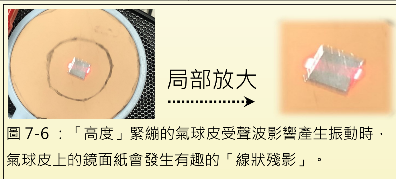
圖 7-6：「高度」緊繃的氣球皮受聲波影響產生振動時，氣球皮上的鏡面紙會發生有趣的「線狀殘影」。
