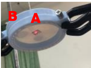
▲ 圖 8-7：A 繃框氣球皮中間黏一鏡面紙，有鏡面紙那面朝下。
