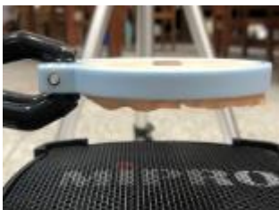
圖 2-9：450W 喇叭距離氣球皮 5cm。
