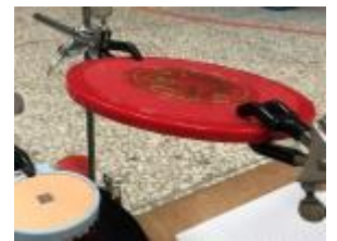
圖 2-4：透過鏡子反射雷射光至方格屏幕。
