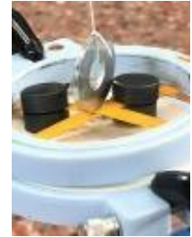
▲ 圖 8-5：鐵片與條狀氣球皮下方鈦鐵硼磁鐵相吸引。
