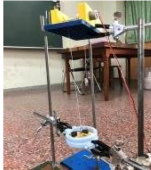
▲ 圖 8-4：減速馬達的設計可收放綁著鐵片的棉繩。
