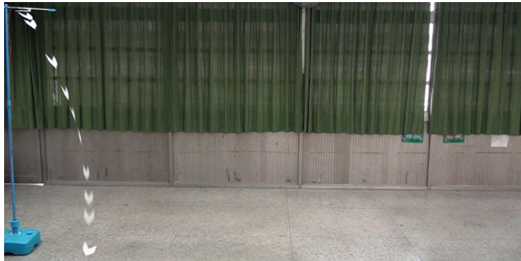
圖 33-1: 距最前端 0.5 公分處配重，配重太重(0.05 克)，下滑的角度太大，前進距離短
