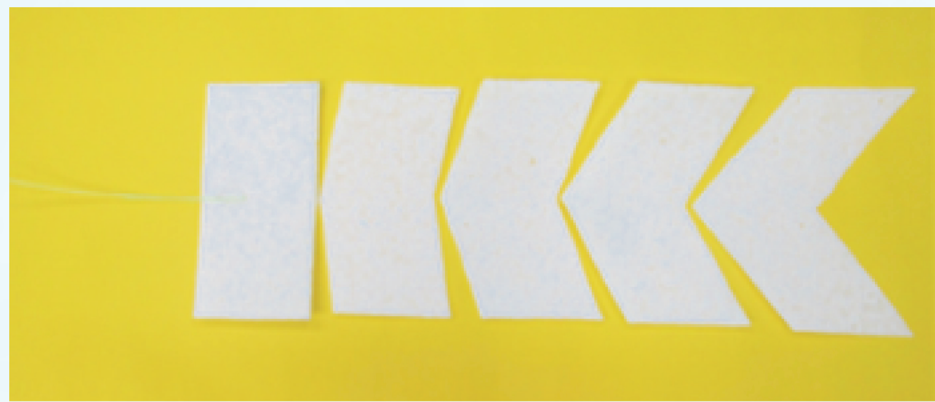
圖34-1: 面積12乘6平方公分、後掠角0-40度的翼，用相同的細長條吸管配重
