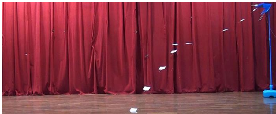
圖 34-2: 後掠角 0 度，翼前緣易抬起失速
