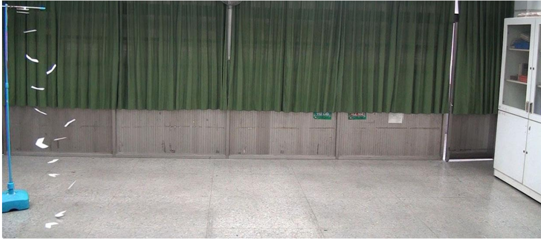
圖 32-1: 在距翼最前端 4.5 公分處配重，下落時直墜，翼前緣抬起，產生失速、前進少
