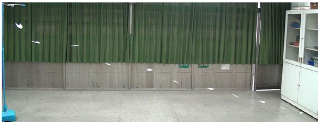
圖 32-3: 在距翼最前端 0.5 公分處配重，下落時翼前緣往下壓，沒有失速現象，往前滑翔
