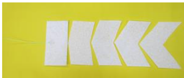
圖 34-1:面積 12 乘 6 平方公分，後掠角 0-40 度的翼，用相同的細長條吸管(0.04g)配重
