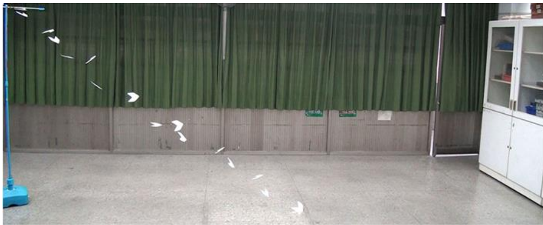
圖 32-2: 在距翼最前端 2.5 公分處配重，下落時翼前緣往下壓，但又再抬起，又重複下壓、抬起多次
