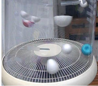
圖 38-1:在風洞測試實體可否停留在空中
