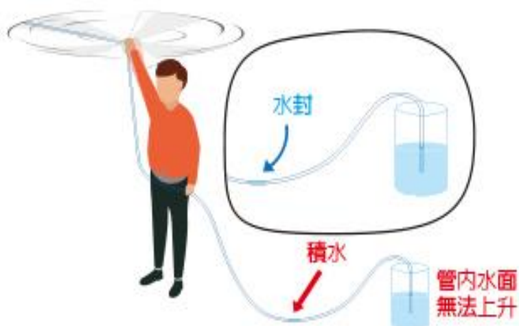
圖 60 水管內水封，導致實驗失敗。
