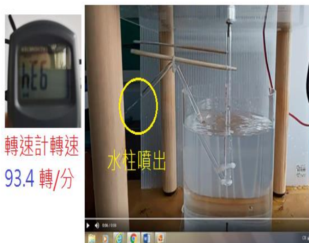
圖 27 管內水面上升 10cm，並噴出水柱。
