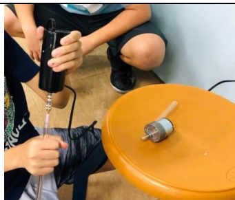
圖 15 利用小型鑽孔機研磨 壓克力管能與馬達轉軸軸心連接
