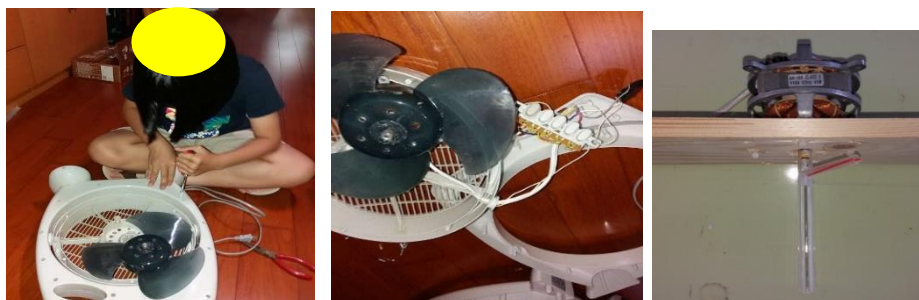
圖 5 將家裡的電風扇馬達拆下，當成研究 2 的第 1 代馬達
