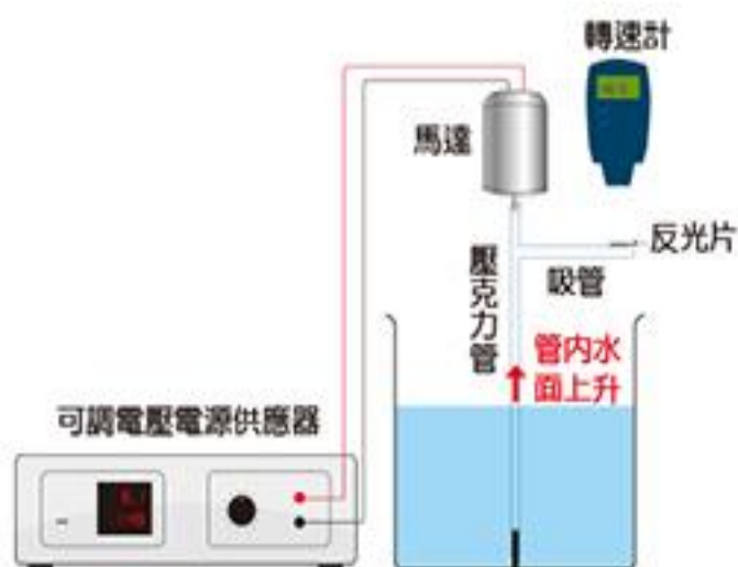
圖 41 實驗儀器示意圖
