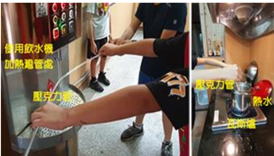
圖 31 使用飲水機熱水及家中瓦斯爐加熱壓克力彎管
