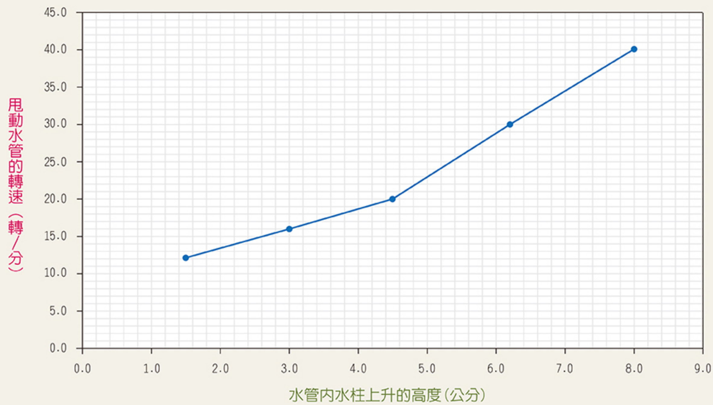
研究1-1 在空氣中甩動水管的轉速與管內水面上升高度的關係圖
