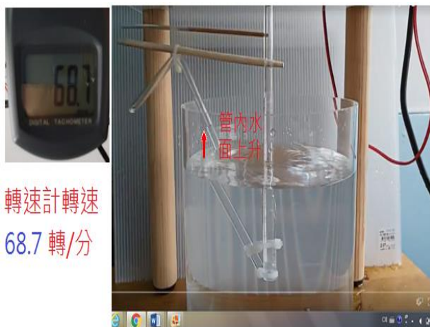
圖 26 低轉速下管內水面上升 3cm
