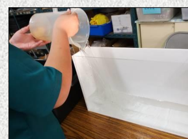
倒水測試水箱是否緊密
