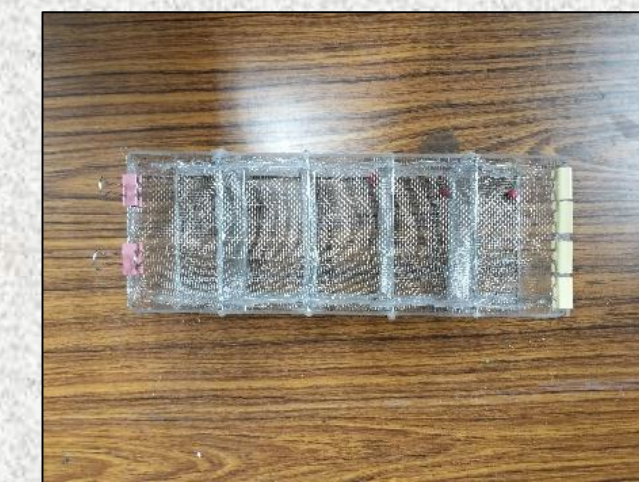
製作水流探測模組之外框
