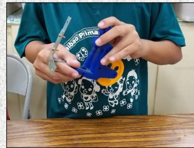
將定滑輪組固定在L型鐵架上
