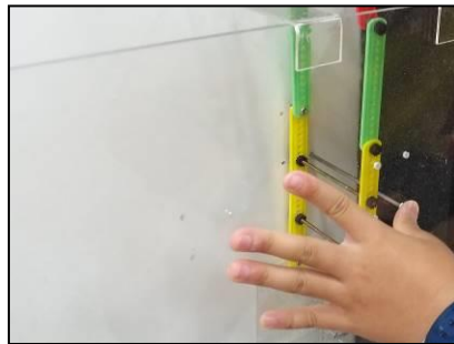
圖 6-16 於機械手臂兩側固定四支鐵棒
