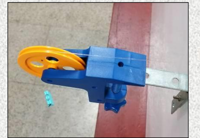
用彈性繩來傳送水輪機的動力
