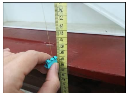
圖 6-26 確認長尾夾上升的高度
