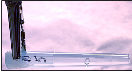
圖八. 移液管大開口以石蠟片密封，尖端開口為 0.5 cm，管內完全注滿二次純水後，水平離開燒杯，管內液體並未滴落造成管內流失，液面微凸。
