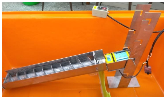
圖 18、19 汲水器裝置之原始概念圖和實際模型
