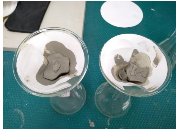
圖 42、43 泥水過濾和完成時照片
