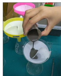
圖12 過濾泥水情形
